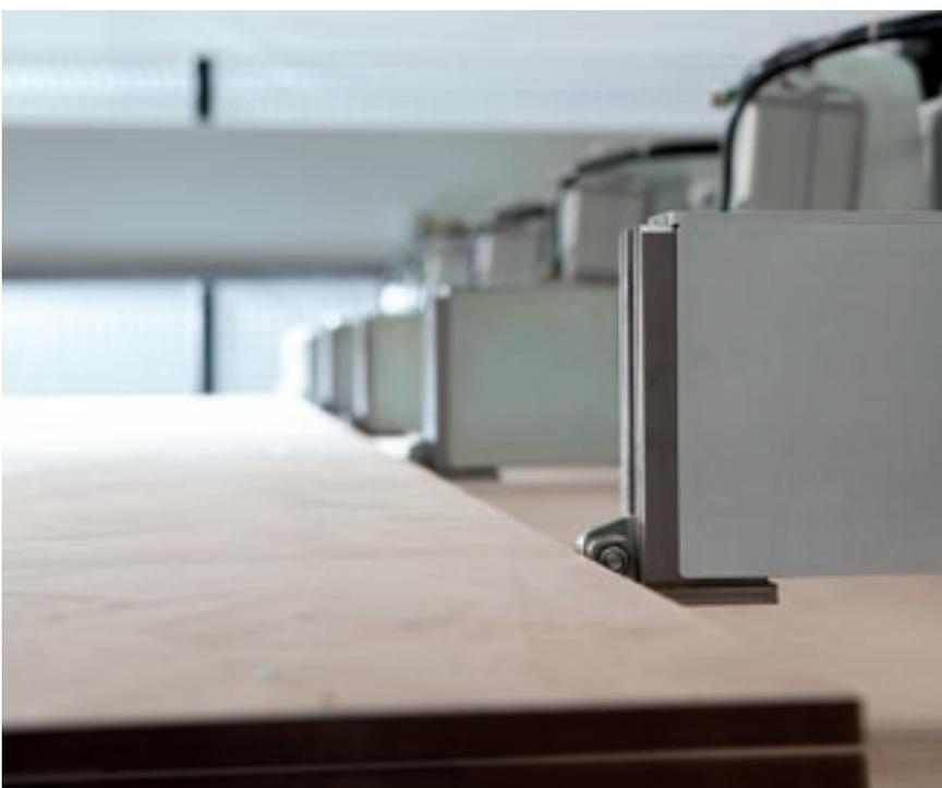
Die **Zangen** entnehmen automatisch die laut Bearbeitungsplan notwendige Plattenmenge. Dadurch erhöhen sich Effizienz und Sicherheit der Plattenaufteilsäge ohne ihren Platzbedarf zu vergrößern.
